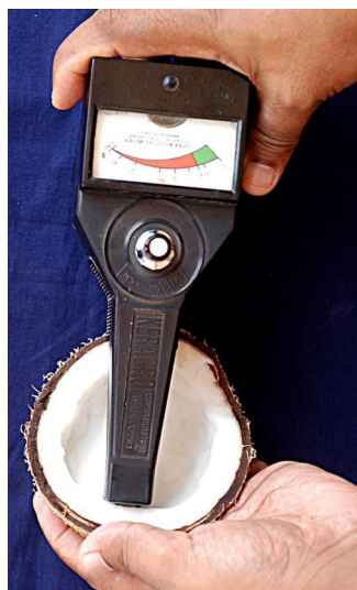
Fig.2.6: Copra moisture meter
